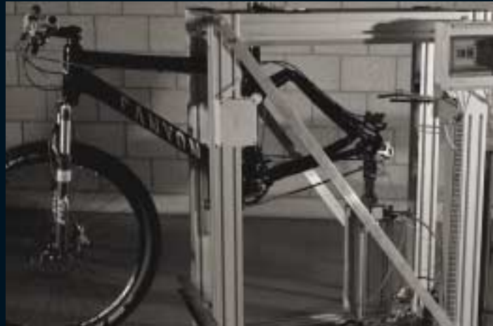
Mit Hilfe des Dämpferprüfstands können Federkennlinie und Rahmenkinematik exakt evaluiert werden.
